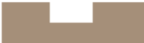
شکل ۲۷- کاهش ضخامت پی در محل چاهک آسانسور
